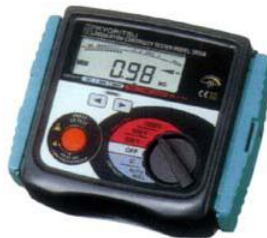
Figura 15 MEDIDOR DE AISLAMIENTO
